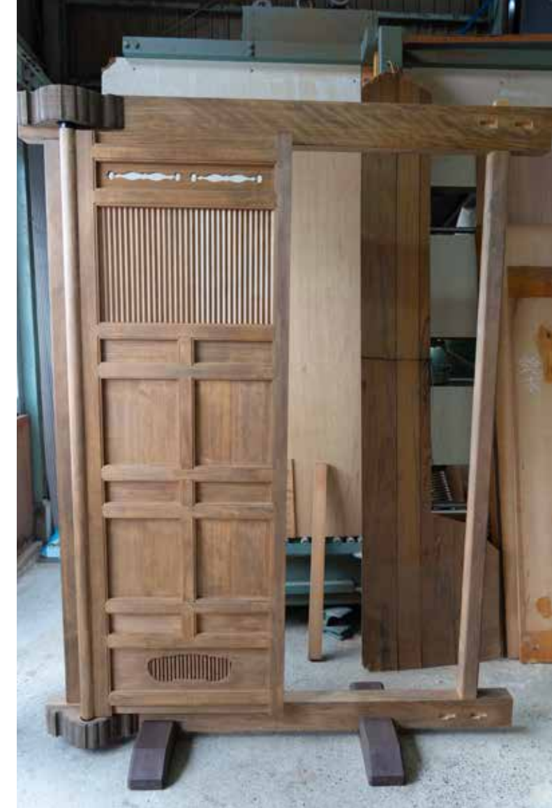
鈴木さんがこれまでに会った最高の仕事が施された棧唐戸の原寸模型 扉左縁が吊元、右縁が手先（全国伝統建具技術保存会製作）
